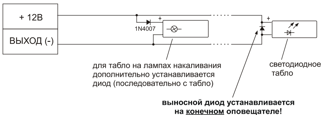
Рис. 6.1. Схема подключения нескольких световых табло
