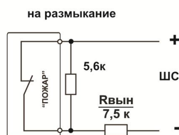
Рис. 3. Организация двухпорогового шлейфа пожарной сигнализации
