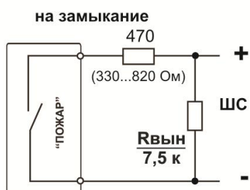
Рис. 3. Организация двухпорогового шлейфа пожарной сигнализации
