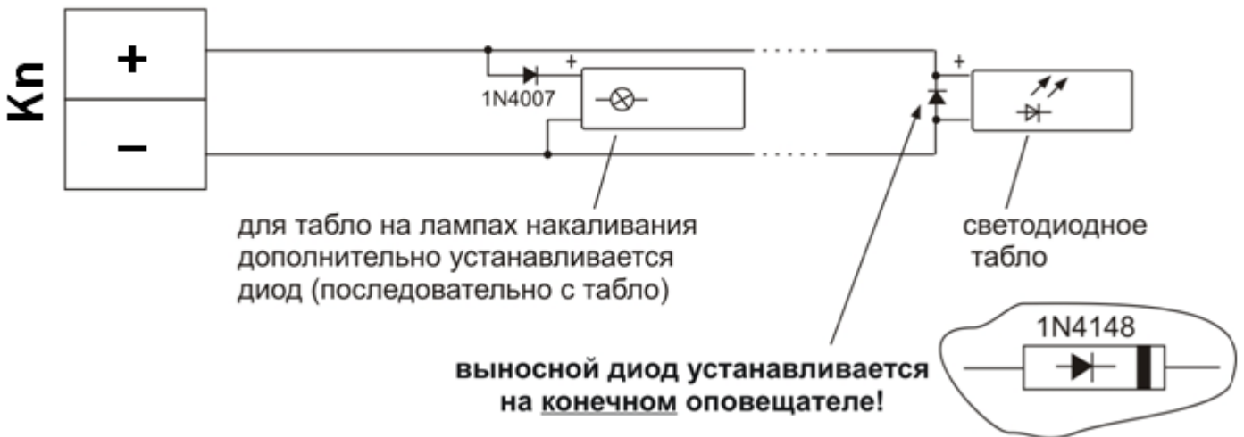
Рис. 21. Схема подключения нескольких световых табло
